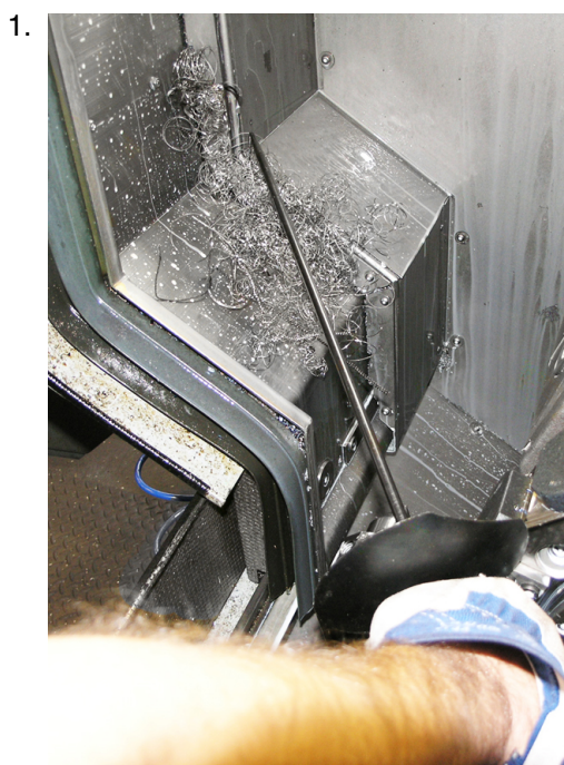
Beispiel: 1 Entfernen der Spänenester mit Hilfe geeigneter Werkzeuge (z.B. Spänehooken)
